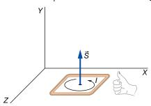
Vemos que el resultado coindice con la ley de Lenz. Puesto que el campo magnético inicialmente apunta hacia  $\vec{j}$ , y va disminuyendo, su flujo magnético va disminuyendo. Luego, sobre la espira se crea una corriente eléctrica cuyo campo magnético tiene que ser hacia  $\vec{j}$  para oponerse al cambio que está ocurriendo.
