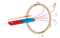
Cuando se aleja el imán del aro (esto es, el polo sur del imán se aleja), se produce una disminución del número de líneas de campo que atraviesan el aro. La corriente que se origine en el aro debe producir un campo magnético,  $\vec{B}'$ , que compense la disminución del flujo experimentado. Por tanto, la corriente inducida originada en el aro circulará en sentido horario:
