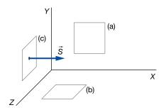
La primera situación, a), indica que el campo magnético no tiene componentes en el eje Z. La segunda, b), indica que tampoco tiene componentes en el eje Y. Y la tercera, c), nos dice que tiene componentes en el eje X.
