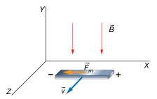
Por tanto, los electrones se desplazan hacia la izquierda en el dibujo. En consecuencia, el polo negativo de la barra será el extremo izquierdo de la barra, y el positivo, el de la derecha.
