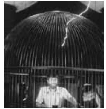
FIGURA 1-36 En la vecindad de esta “caja de Faraday” existe un intenso campo eléctrico, tan intenso que los electrones que rondan en la atmósfera son acelerados a la EC necesaria para sacar electrones de los átomos de aire, lo que provoca una avalancha de carga que fluye hacia (o desde) la caja metálica. Aunque la persona en el interior de este dispositivo no resulta afectada.
