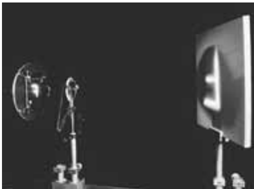
FIGURA 8-30 La lente convergente (en el soporte) forma una imagen ("F" grande sobre la pantalla de la derecha) de un objeto brillante ("F" iluminada a la izquierda).
