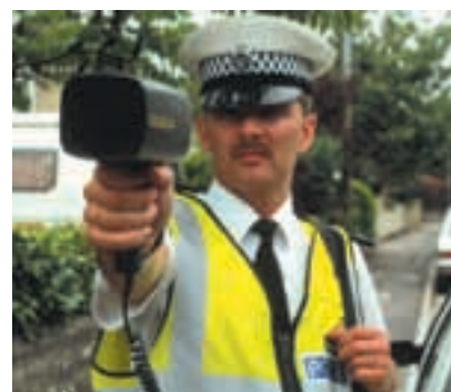
10.16 Este cañón manual de radar emite un haz de radio de frecuencia f_0 , el cual, en el marco de referencia de un automóvil que se aproxima, tiene una frecuencia f más alta dada por la ecuación (10.25). El haz reflejado también tiene una frecuencia f en el marco del auto, pero tiene una frecuencia f' aún más alta en el marco del policía. El cañón de radar calcula la rapidez del auto comparando las frecuencias del haz emitido y del haz doblemente reflejado y con desplazamiento de Doppler.
