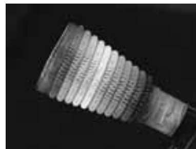
FIGURA 3-16 El elemento calefactor en forma de bobina de un calentador eléctrico de espacio a causa de la energía transformada por la corriente eléctrica.
