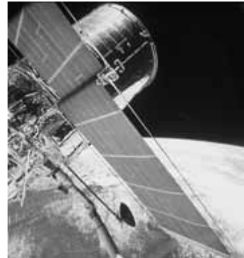
FIGURA 9-31 El Telescopio Espacial Hubble con la Tierra como fondo. Los paneles planos son celdas solares que captan energía proveniente del Sol.
