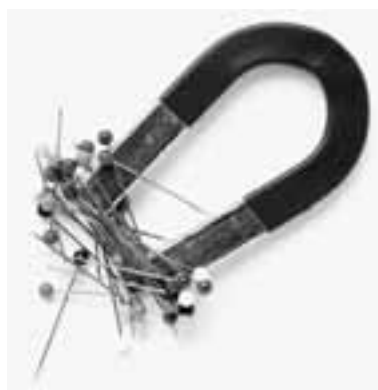
FIGURA 5-1 Un imán de herradura atrae alfileres.
