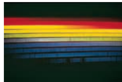
11.12 Espectro de absorción del Sol. La atmósfera solar es relativamente fría y absorbe fotones, en forma selectiva, de la superficie incandescente del Sol, produciendo líneas de absorción oscuras. Las longitudes de onda de las líneas oscuras indican qué clases de átomos hay en la atmósfera solar.
