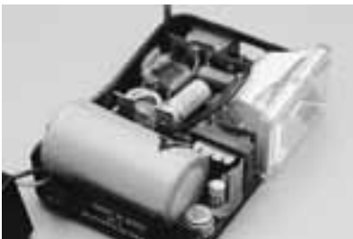
FIGURA 2-17 Unidad de flash de cámara.
