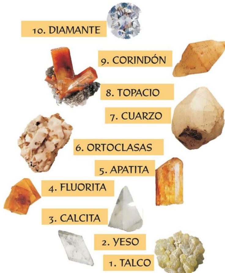
ESCALA DE DUREZA DE LOS MINERALES
