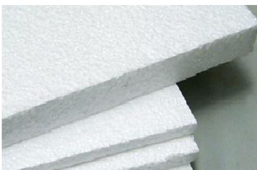
POREXPAN (mal conductor térmico, buen aislante térmico)
