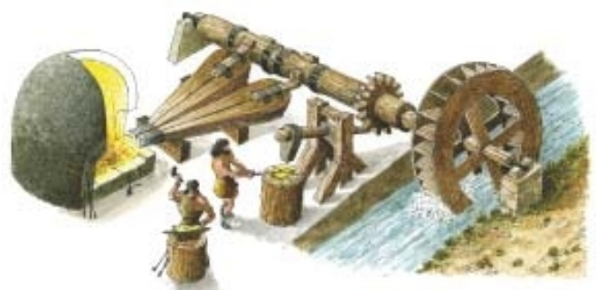
Fig 1: Fragua hidráulica. La fuerza del agua movía el martillo, facilitando la labor para elaborar todo tipo de herramienta
