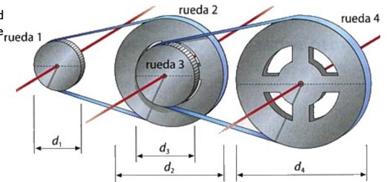
43. La figura muestra el sistema de poleas de un taladro. Según la combinación de poleas que elijamos podemos utilizar diferentes velocidades de giro de la broca.
