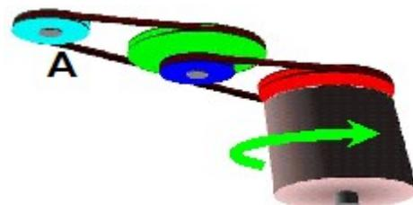
31. En el siguiente mecanismo la potencia total del motor se distribuye a tres árboles conducidos distantes (A,B y C), mediante transmisiones por correa.
