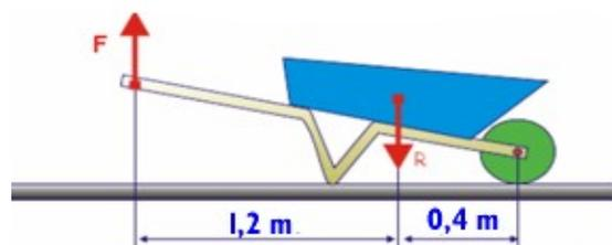
13. Calcular la fuerza que tendré que hacer para mover una piedra de 90 Kg con la palanca mostrada en la figura. ¿De qué grado es dicha palanca?
