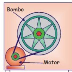
Si sustituimos la polea del motor por una que sea el doble de grande, ¿qué le pasará a la velocidad de centrifugado (de giro)?
