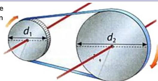
41. El motor de una lavadora está unido a una polea de 8 cm de diámetro, mientras que el bombo lo está a una polea de 32 cm. La velocidad máxima de giro del bombo al centrifugar es de 1200 rpm. ¿A qué velocidad debe girar el motor?
