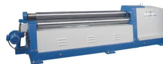
Máquina para doblar chapas compuesta por cuatro cilindros.
