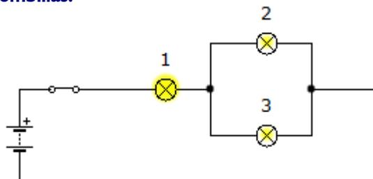
Estos circuitos poseen las características de los dos circuitos, por lo que se tiene que resolver poco a poco por partes. En primer lugar se resuelven los elementos
