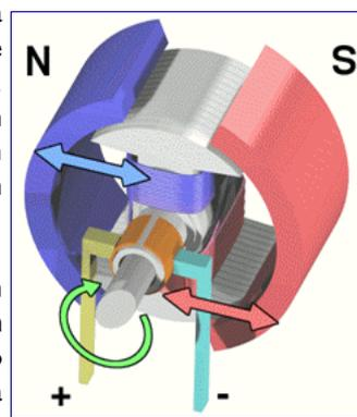
Su funcionamiento se basa en el fenómeno de **inducción electromagnética**. En dicho efecto, la corriente que pasa por un conductor genera a su alrededor un campo electromagnético, comportándose como un imán. Este efecto se utiliza en los motores eléctricos, los cuales aprovechan las fuerzas de atracción y repulsión entre un imán y un hilo conductor enrollado colocado en su interior. Estas fuerzas provocan el movimiento del eje del motor.
