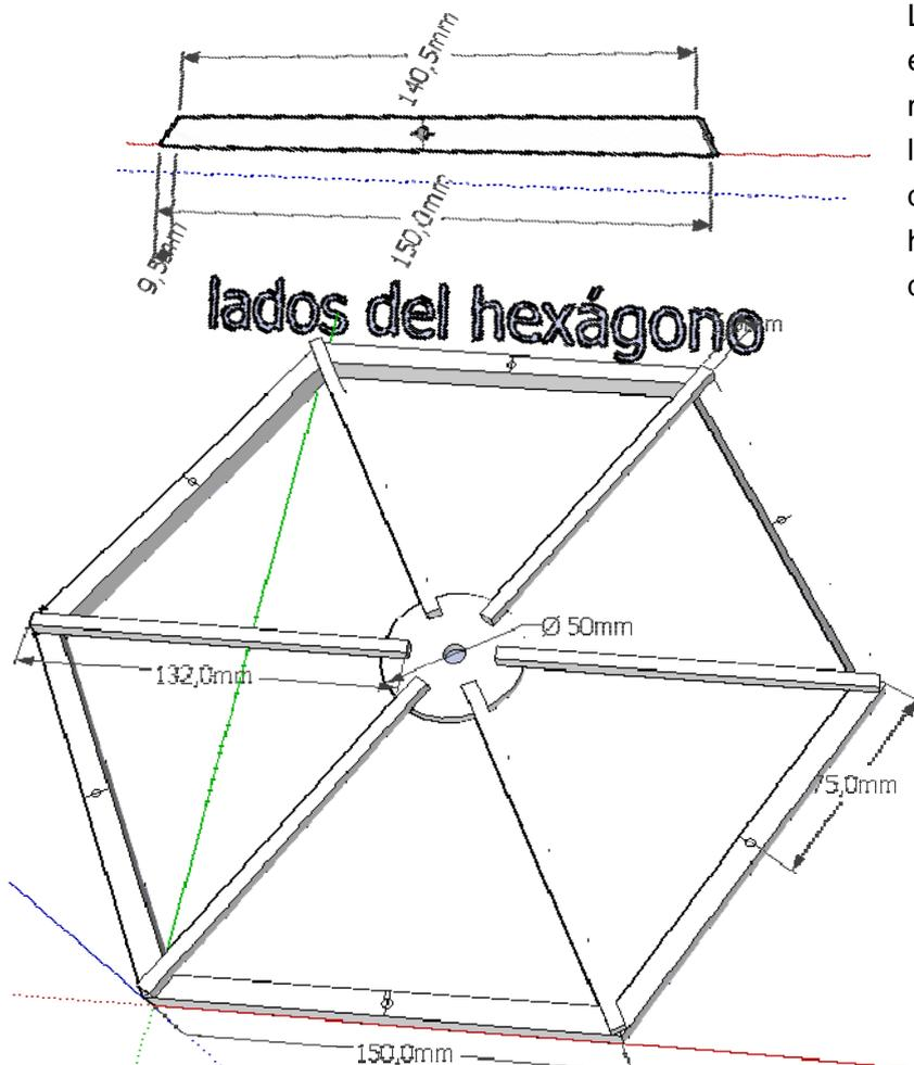
Los lados del hexágono se realizarán con el listón de pino (9,5 mm x 9,5 mm x 2 000 mm). Una vez que se tenga la medida del lado y del ángulo, se cortarán los 6 lados del hexágono. En el medio de cada lado hay que realizar un taladro con la broca del 3.
