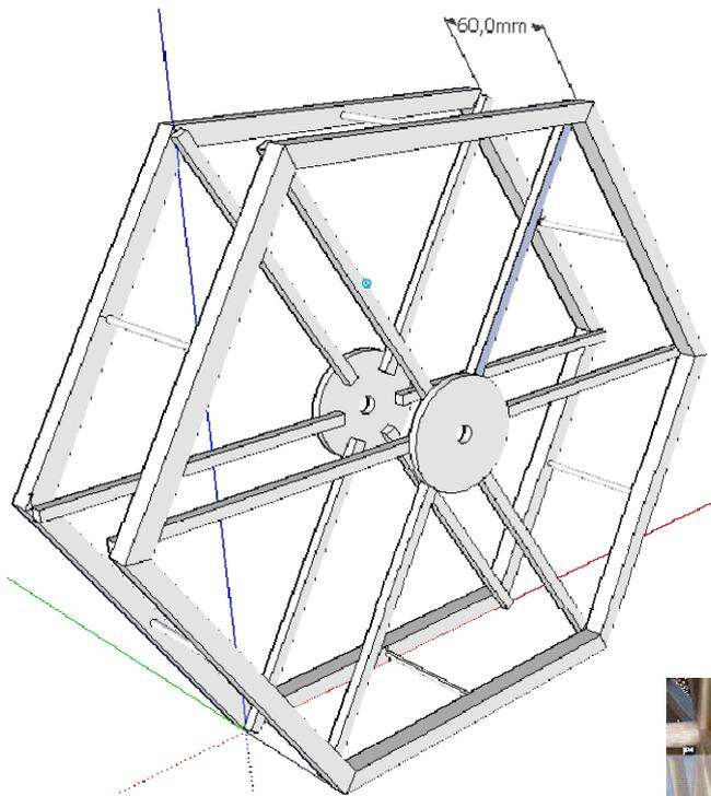
Cuando se tengan las dos caras totalmente terminadas se lijarán bien y a continuación se unirán mediante las 6 varillas de Ø3mm donde irán colgando los barquillos. Después colocaremos las varilla roscada M4x160mm con las tuercas
