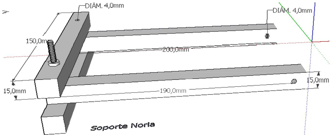
La unión de los soportes se realizará con 2 varillas M4 x 60 mm 4 tuercas y 4 arandelas. En la figura se pueden ver las medidas de los listones y dónde realizar los taladros.
