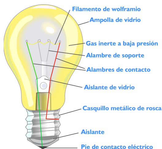
Fig 15: Esquema de una lámpara incandescente.
