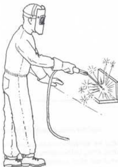
Soldadura con arco eléctrico
