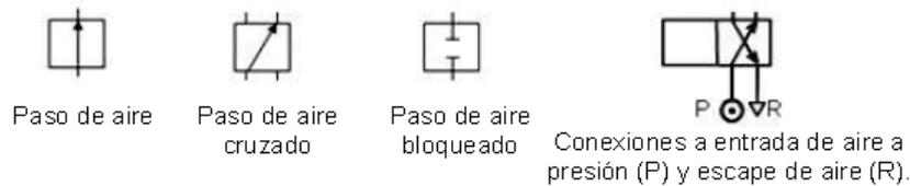
**b) Accionamiento de la válvula:** Un parámetro importante de las válvulas es cómo se accionan: la activación puede ser manual (por pulsador, por pedal, etc.), mecánica (por leva, por final de carrera, etc.), neumática (mediante aire comprimido), o eléctrica (mediante una señal eléctrica que activa un electroimán o un relé).
