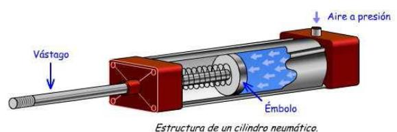
introducido en el interior del cilindro desplaza un émbolo móvil, que está conectado a un eje (vástago).
