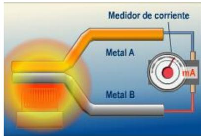
El **termopar** es un sensor formado por dos metales distintos que se unen por uno de sus extremos. Cuando esta unión se calienta, se genera una **diferencia de potencial** entre sus extremos libres. Esta diferencia de potencial cambiará según las variaciones de temperatura.
