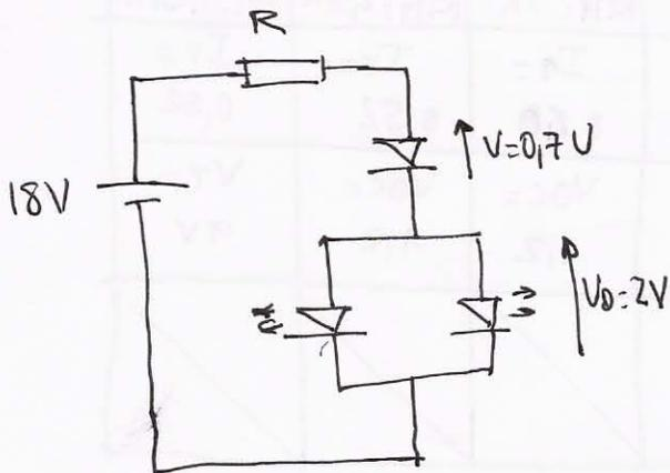
B) Por la rama de la izquierda no pasa  $I_{int}$ , ya que el diodo está en Polarización inversa (circuito abierto)
