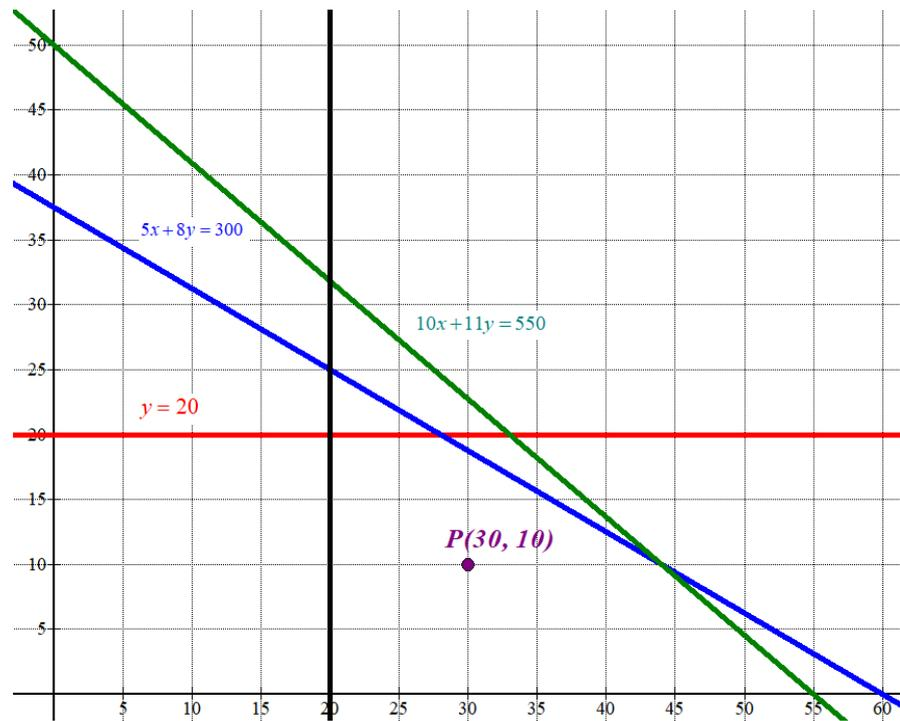
$$\left. \begin{array}{l} x \geq 20 \\ y \leq 20 \\ \text{Como las restricciones son } 10x + 11y \leq 550 \\ 5x + 8y \leq 300 \\ x \geq 0; y \geq 0 \end{array} \right\} \text{ la región factible es la zona del primer}$$
