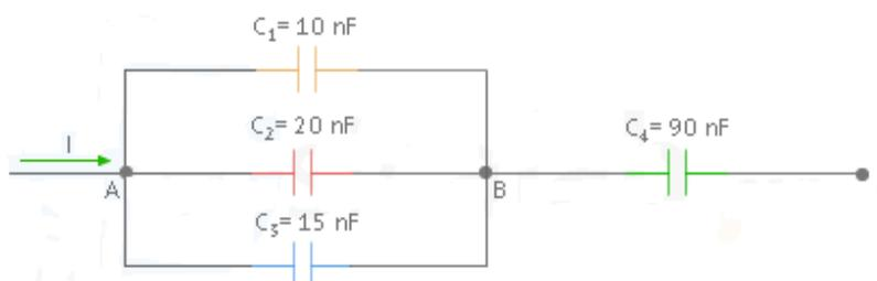
Calcular el valor del condensador equivalente que se obtiene al asociar los cuatro condensadores.
