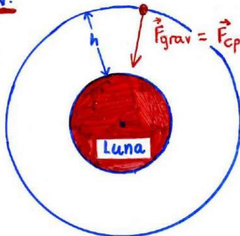
Si el vehículo espacial describe un movimiento circular uniforme en torno a la Luna, que equivale a una partícula de masa la total:  $m_L$ , situada en el centro del astro (teorema de Gauss), es debido a la identidad entre las fuerzas gravitatoria y centrípeta.
