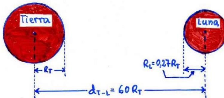
Según el teorema de Gauss, la Tierra y la Luna equivalen a sendas partículas, de masas las totales:  $m_T$  y  $m_L$ , situadas en sus respectivos centros. Con esto, y aplicando la ley de gravitación universal:
