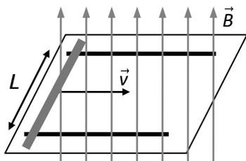
La dirección y el sentido de  $\vec{F}_m$  se determinan por la regla de la mano derecha (ver figura inferior). Esto hace que en un extremo del conductor se acumule la carga positiva y en el otro la negativa.
