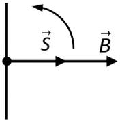
**Apartado a)** La figura esquematiza la espira cuadrada (vista de perfil) que gira en el interior de un campo magnético constante. Como no nos dicen cual es la posición de la espira cuando se empieza a contar el tiempo, la colocamos en la posición más fácil, que es perpendicular al campo magnético (vectores  $\vec{S}$  y  $\vec{B}$  paralelos).
