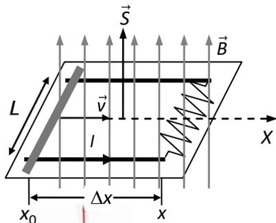
Hagamos que el conductor se mueva en el sentido positivo del eje  $OX$  (ver figura) y supongamos que en el intervalo de tiempo  $\Delta t$  se desplaza desde el punto  $x_0$  al  $x$ , entonces el desplazamiento es  $\Delta x = x - x_0$ .
