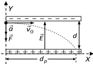
Sabemos que en dentro del condensador el campo eléctrico es constante y que está dirigido de la placa positiva a la negativa, como se ve en la figura. Por otro lado, de la ecuación  $F = qE$  deducimos que, puesto que la carga del electrón es negativa, la fuerza eléctrica tiene sentido opuesto al campo; es decir, es vertical y dirigida hacia abajo (ver figura). Observa que la ecuación está en su forma escalar porque la fuerza y el campo tienen la dirección del eje  $OY$ .
