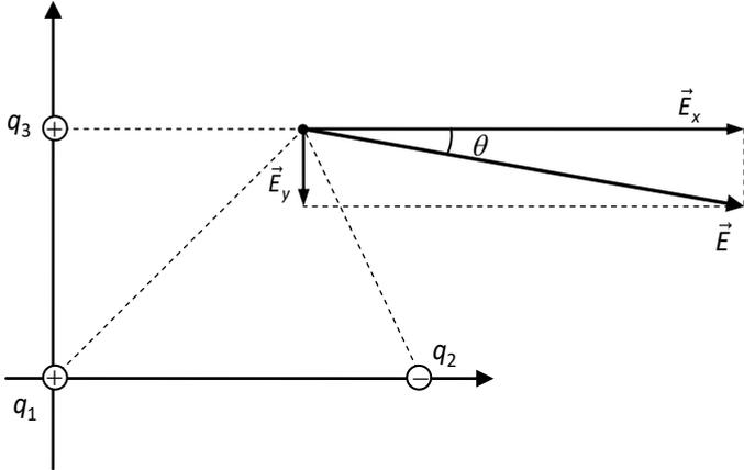
En la figura se ha dibujado el vector que representa al campo creado por las tres cargas y sus componentes.
