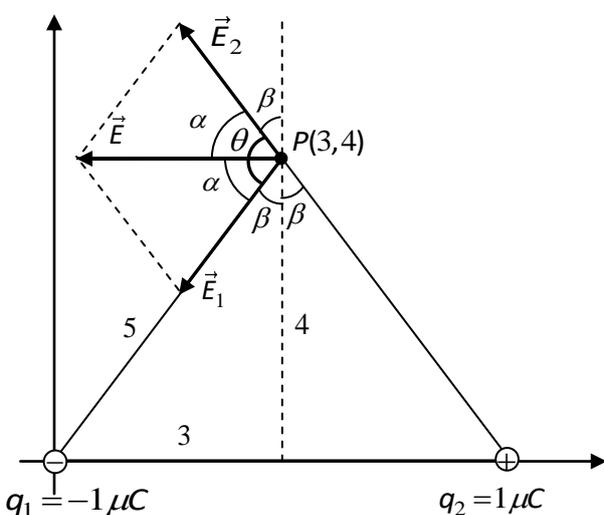
La figura muestra las intensidades de los campos creados por  $q_1$  y  $q_2$  en  $P$  y la intensidad del campo total, que es la suma vectorial de los anteriores.
