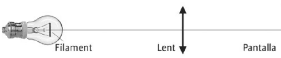
$$s' = 21 \text{ cm. (pues es real)} \left. \vphantom{s'} \right\} \begin{array}{l} f' = 12 \text{ cm.} \\ \rightarrow \frac{1}{s'} - \frac{1}{s} = \frac{1}{f'} \end{array} \rightarrow s = -28 \text{ cm.}$$
