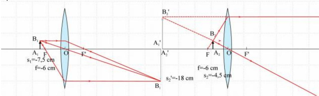
Un sistema óptico está formado por dos lentes convergentes, la primera de potencia: 5 dioptrías y la segunda de 4 dioptrías; ambas están separadas 85 cm y tienen el mismo eje óptico. Se sitúa un objeto de tamaño: 2 cm delante de la primera lente, perpendicular al eje óptico, de manera que la imagen formada por ella es real, invertida y de doble tamaño que el objeto.
