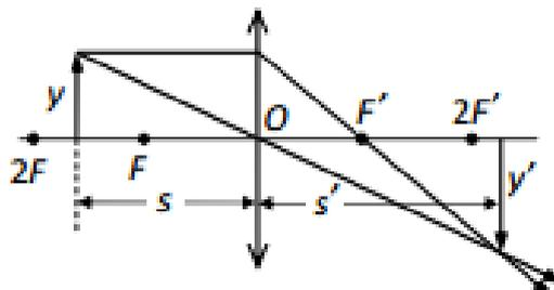
Un objeto luminoso está situado a 6 m de una pantalla. Una lente, cuya distancia focal es desconocida, forma sobre la pantalla una imagen real, invertida y cuatro veces mayor que el objeto.
