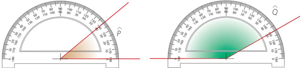
La intersección de la parte inferior del transportador coincide con el vértice del ángulo, y el lado inferior del ángulo pasa por el 0 del transportador.
