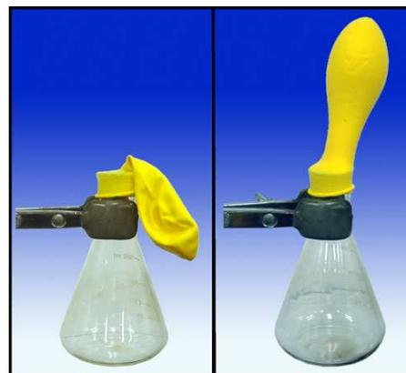
Si calientas el erlenmeyer con la llama de un mechero bunsen o en una placa calefactora, puedes observar que el globo se hincha, y que cuando después dejas enfriar hasta temperatura ambiente, vuelve a la situación inicial.
