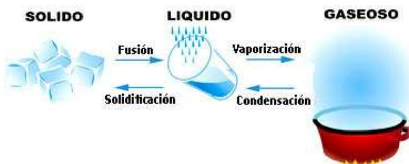
Observa en las simulaciones cómo se producen estos cambios de estado desde el punto de vista experimental, fijándote especialmente en cómo varía la temperatura durante el proceso: permanece constante mientras se produce el cambio de estado.
