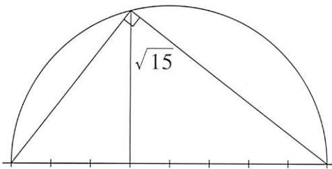
Por el teorema de la altura  $h^2 = 3 \cdot 5 \rightarrow h = \sqrt{15}$  y solo queda trasladar esta altura a la recta real empleando un compás.
