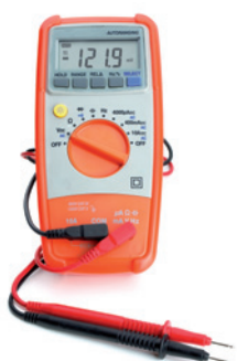
Polímetro digital. Mide intensidades y voltajes.
