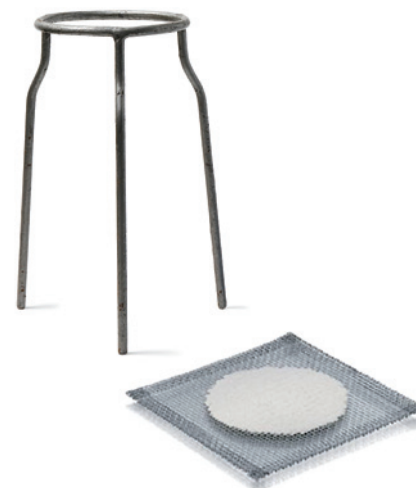
Trípode y rejilla de cerámica. Sirven para colocar recipientes sobre el mechero de Bunsen.
