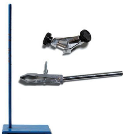
Soporte, pinza y nuez. Sujetan instrumentos diversos en los montajes de laboratorio.
