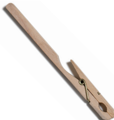
Pinza de madera. Sujeta los tubos de ensayo, para calentarlos y para llevar a cabo reacciones químicas.
