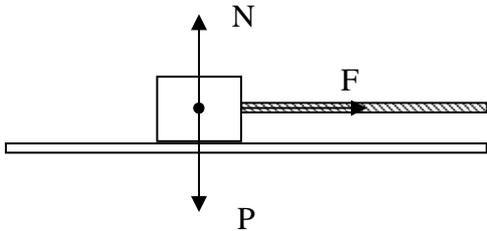
En ausencia de rozamiento, la tensión de la cuerda es la fuerza que arrastra al objeto. Esta fuerza debe valer, como máximo, 200 N. Aplicando el principio fundamental de la dinámica:  $F = m \cdot a$ , podemos calcular la aceleración:
