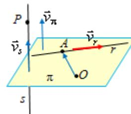
El plano pedido viene determinado por el punto  $O$  y por los vectores  $OA = (0, -5, 2)$  y el de dirección de la recta,  $\vec{v}_r = (1, 2, -1)$ .
