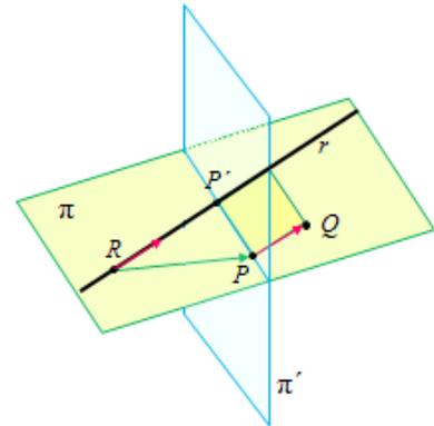
c) Por ejemplo,  $P'$ , que será el proyectado de  $P$  sobre  $r$ . Dicho punto se obtiene mediante el corte de la recta con el plano  $\pi'$ , que contiene a  $P$  y es perpendicular a la recta  $r$ . Su vector característico es:  $\vec{v}_{\pi'} = \vec{v}_r = (-1, 2, -2)$ .
