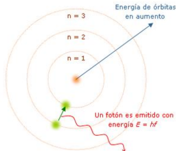
Transiciones energéticas de los electrones entre los distintos niveles de energía Figura 8.4
