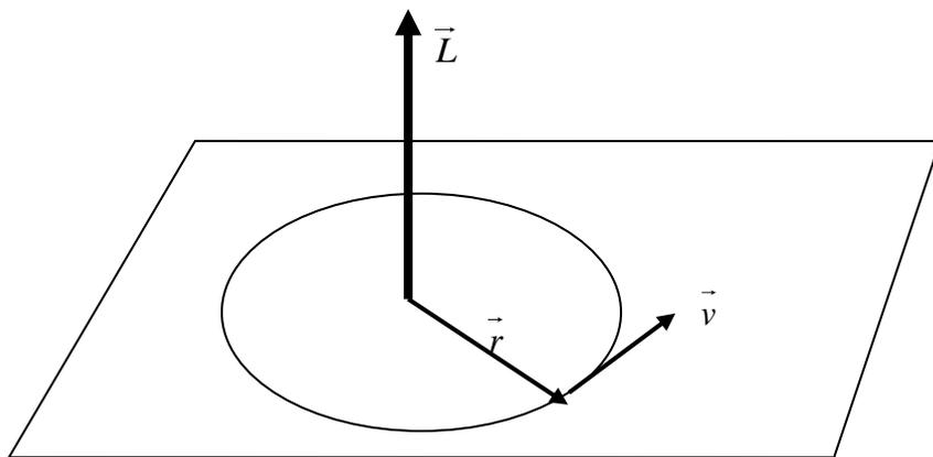
El movimiento es plano (plano del círculo) y los vectores  $\vec{r}$  y  $\vec{v}$  son perpendiculares entre sí. El momento angular es entonces perpendicular al círculo. Este es el caso del movimiento de la Tierra alrededor del Sol. El vector de posición  $\vec{r}$  coincide con el radio del círculo por lo que es perpendicular al vector velocidad  $\vec{v}$  en todo momento.
