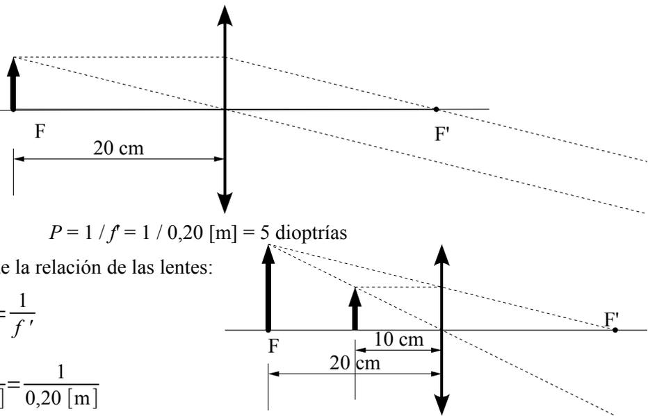
Si colocamos el objeto a la distancia inferior a la distancia focal, la imagen se forma antes de la lente, es virtual y no se puede recoger en una pantalla.
