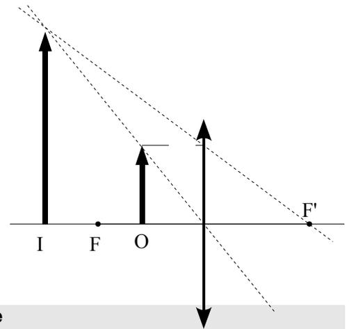
17. Si en la práctica de óptica geométrica la lente convergente tiene una distancia focal imagen de + 10 cm, ¿a qué distancias de la lente puedes situar el objeto para obtener imágenes sobre la pantalla, si se cumple que  $|s| + |s'| = 80$  cm? Dibuja la marcha de los rayos.
