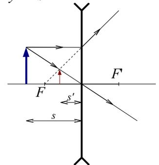
3. Un objeto de 3 cm de altura se sitúa a 75 cm de una lente delgada convergente y produce una imagen a 37,5 cm a la derecha de la lente:
