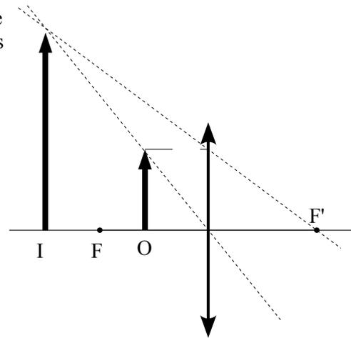
**15. Haz un esquema de la práctica de óptica, situando el objeto, la lente y la imagen, y dibujando la marcha de los rayos para obtener una imagen derecha y de mayor tamaño que el objeto.**
