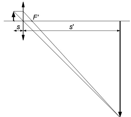
**5. Un objeto de 3 cm de altura se coloca a 20 cm de una lente delgada de 15 cm de focal. Calcula analítica y gráficamente la posición y tamaño de la imagen:**
