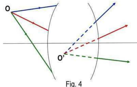
Cuando se acoplan dos sistemas, la imagen que produce el primero sirve de objeto para el segundo.
