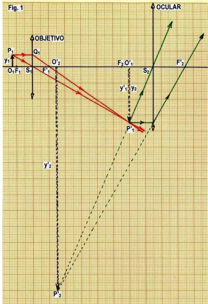
+ **Enfoque:** La distancia objetivo-ocular en un microscopio es constante. Por tanto, para enfocar el objeto iluminado se debe desplazar mediante una cremallera el cuerpo completo del microscopio, variando su distancia  $O_1F_1$  al objeto. Estos movimientos siempre son muy finos, para un enfoque perfecto, por lo que también los microscopios suelen llevar un tornillo micrométrico de avance muy lento para el afinado del enfoque.
