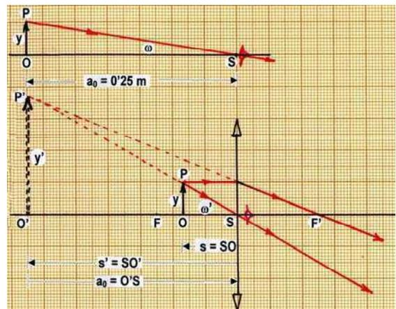
Para observar con la lupa en condiciones comparables, pongamos el mismo objeto  $y = OP$  en un punto  $O$  de modo que la imagen virtual  $y' = O'P'$  se forme en la posición  $s' = -a_0 = -0.25 \text{ m}$  respecto de la lupa. Si en estas condiciones suponemos el ojo inmediato a la lente junto al punto  $S$ , veremos la imagen  $y'$  bajo un ángulo  $\omega'$ . De acuerdo con la figura anterior:
