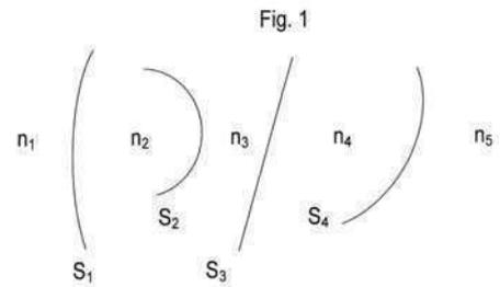
Si el sistema está formado únicamente por superficies refractantes, se llama **dióptrico**; si sólo contiene espejos, **catóptrico**, y si participa de ambas, **catadióptrico**.
