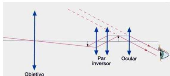
Este par modifica la orientación de la imagen sin modificar su tamaño, consiguiéndose así la visión directa del objeto observado. Este proceso de inversión se traduce en un aumento de longitud del tubo del catalejo, problema éste que se puede solucionar diseñando el dispositivo de manera que conste de varios tubos que pueden penetrar uno en otro, formando un conjunto plegable.
