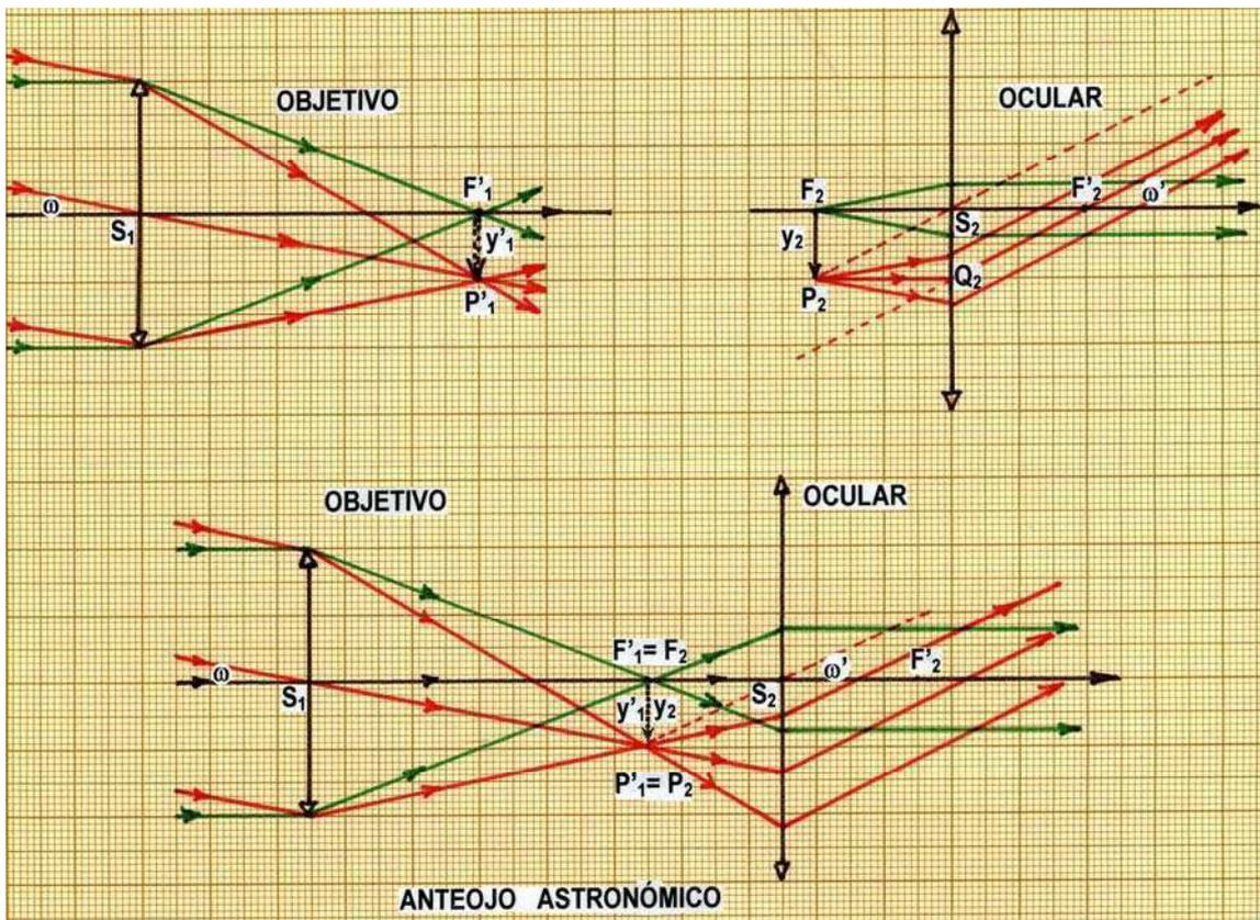
+ Observación: El conjunto de ambos sistemas (figura inferior) se acopla de modo que coincidan el foco imagen del objetivo con el foco objeto del ocular. De este modo, un objeto real en el infinito, que subtende con el observador un ángulo visual  $\omega$ , es visto por el ojo bajo un ángulo  $\omega'$ , mayor, procedente de una imagen virtual e invertida.
