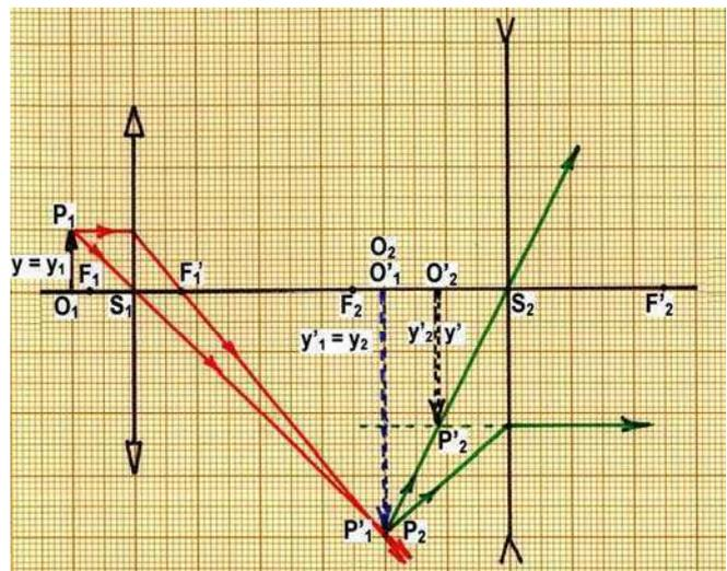
+ Lente 2ª:  $-\frac{1}{s_2} + \frac{1}{s'_2} = \frac{1}{f'_2}$  donde  $s_2 = -10 \text{ cm}$  y  $f'_2 = -12 \text{ cm} \Rightarrow s'_2 = -5,46 \text{ cm}$
