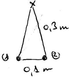
$$V_1 = V_2 = \frac{k \cdot q}{r} = \frac{9 \cdot 10^9 \cdot 5 \cdot 10^{-6}}{0,3} = 1,5 \cdot 10^5 \text{ V}$$
