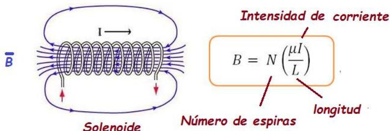
Un solenoide es cualquier dispositivo físico capaz de crear un campo magnético sumamente uniforme e intenso en su interior, y muy débil en el exterior. Un ejemplo teórico es el de una bobina de hilo conductor aislado y enrollado helicoidalmente, de longitud indeterminada.
