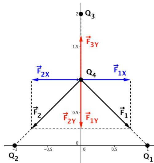
Podemos ver claramente en el esquema que, debido a la simetría del problema ( $Q_1 = Q_2$  y  $Q_4$  se encuentra a la misma distancia de las dos cargas anteriores) las componentes horizontales  $\vec{F}_{1x}$  y  $\vec{F}_{2x}$  son iguales en módulo y de sentidos opuestos. Por lo tanto:
