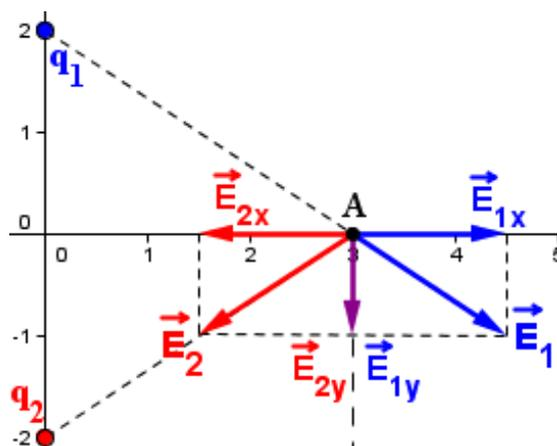
Calculamos primero el módulo de  $\vec{E}_1$  y  $\vec{E}_2$ . Para ello debemos conocer antes la distancia entre las cargas y el punto A. Aplicamos el teorema de Pitágoras:
