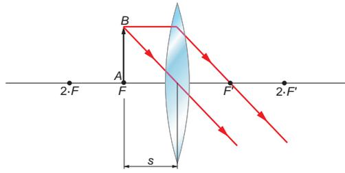
Imagen formada por una lente convergente de un objeto cuya distancia objeto es igual a la distancia focal objeto,  $s = F$ . Como vemos, no se forma imagen, ya que los rayos se cortan en el infinito.
