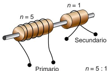
Para lograr que la relación de transmisión sea 5, en uno de los lados, el número de vueltas del cable alrededor de la barra ha de ser 5 veces superior al del otro. Este será el primario del transformador, mientras que el arrollamiento del otro extremo será el secundario.
