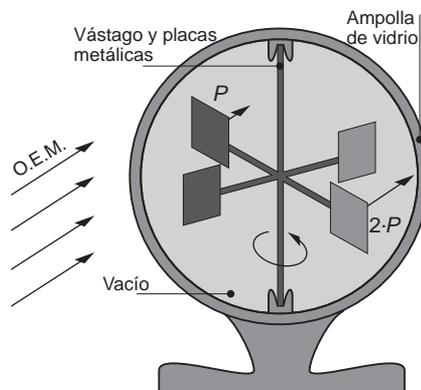
En dicho dispositivo existe un “molinete” metálico encerrado en el interior de una ampolla de vidrio a la que se ha hecho el vacío. En las cuatro aspas del molinete, una parte está pintada de negro mate, y la otra es una superficie metálica reflectante.
