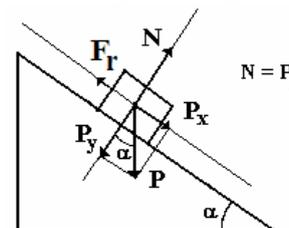
**8.- Una fuerza de 490 N tira de un bloque, inicialmente en reposo que pesa 20 kg, situado en un plano inclinado 30° sobre la horizontal. La fuerza actúa hacia arriba y paralelamente al plano, y de esta forma el cuerpo recorre 10 m. Se sabe que el coeficiente de rozamiento es 0'2. Calcular: a) el trabajo realizado por la fuerza y su distribución, b) la velocidad adquirida por el cuerpo al final del recorrido c) Trabajo de la fuerza de rozamiento.**
