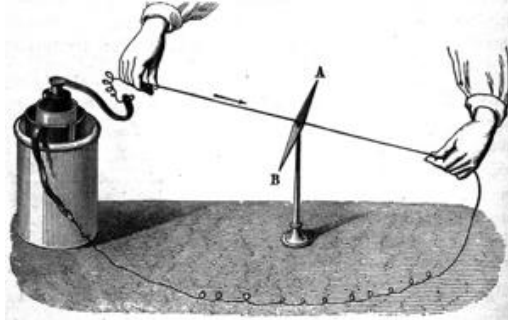
Experiencia de Oersted (1820) mostrando como una corriente eléctrica desvía una aguja imantada
