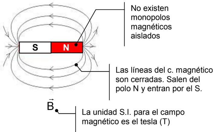
Las cargas eléctricas en movimiento **interaccionan** con el campo magnético
