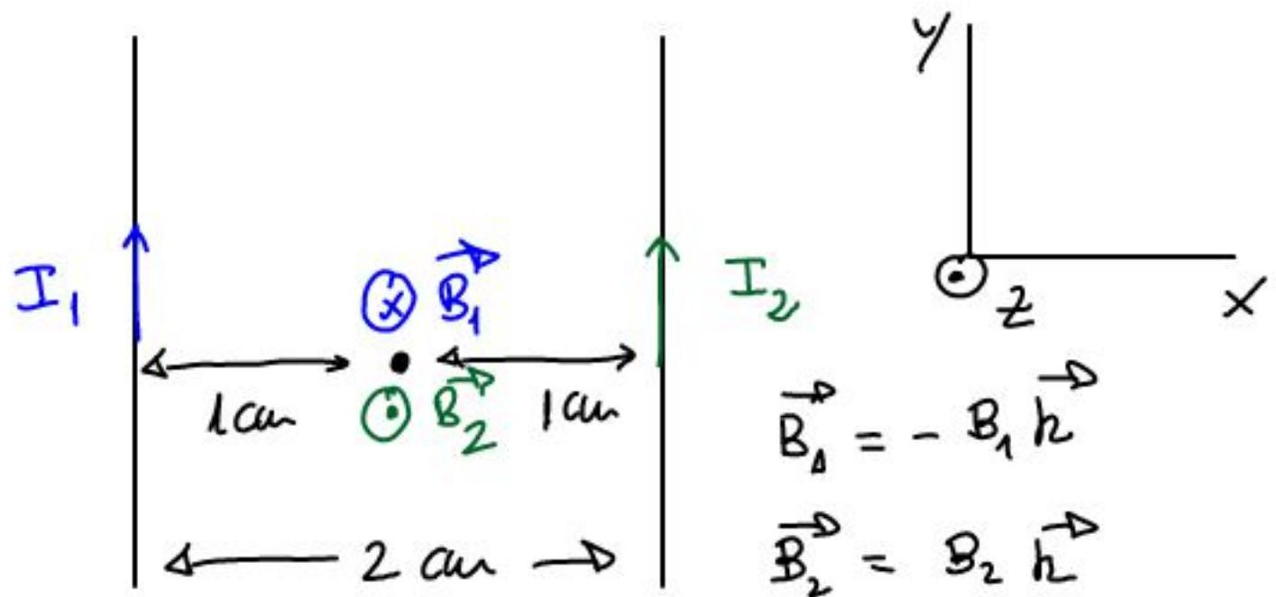
$$\vec{B} = \vec{B}_1 + \vec{B}_2 = (B_2 - B_1) \vec{k} = - (B_1 - B_2) \vec{k}$$
