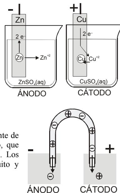
La reacción puede interrumpirse y volver a ponerse en marcha acoplado un interruptor al cable, permitiendo o impidiendo el paso de electrones del cátodo al ánodo.
