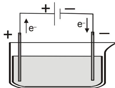
Si introducimos en una celda que contiene cloruro de sodio disuelto en agua, dos electrodos inertes (generalmente grafito), que no reaccionan químicamente con los iones  $\text{Na}^+$  y  $\text{Cl}^-$ , ocurre lo siguiente:
