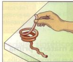
Figura 4.8(b). Plasticidad. Habilidad de un material para conservar su nueva forma una vez deformado. Es opuesta a la elasticidad.
