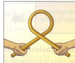
Figura 4.8(c). Ductilidad. Es la capacidad que tiene un material para estirarse en hilos (por ejemplo, cobre, oro, aluminio, etc.).
