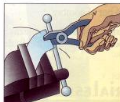
Figura 4.8(h). Fatiga. Deformación (que puede llegar a la rotura) de un material sometido a cargas variables, inferiores a la de rotura, cuando actúan un cierto tiempo o un número de veces determinado.
