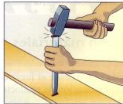
Figura 4.8(e). Dureza. Oposición que ofrece un cuerpo a dejarse rayar o penetrar por otro o, lo que es igual, la resistencia al desgaste.
