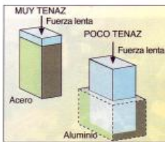
Figura 4.8(g). Tenacidad. Resistencia que opone un cuerpo a su rotura cuando está sometido a esfuerzos lentos de deformación.
