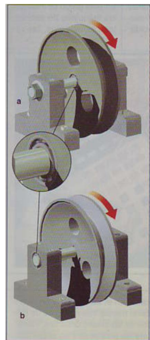
Fig. 2. Tipos de ejes: a) fijo; b) giratorio.
